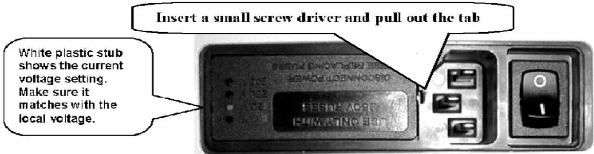
Figure 3.7. AC inlet on CEU.
